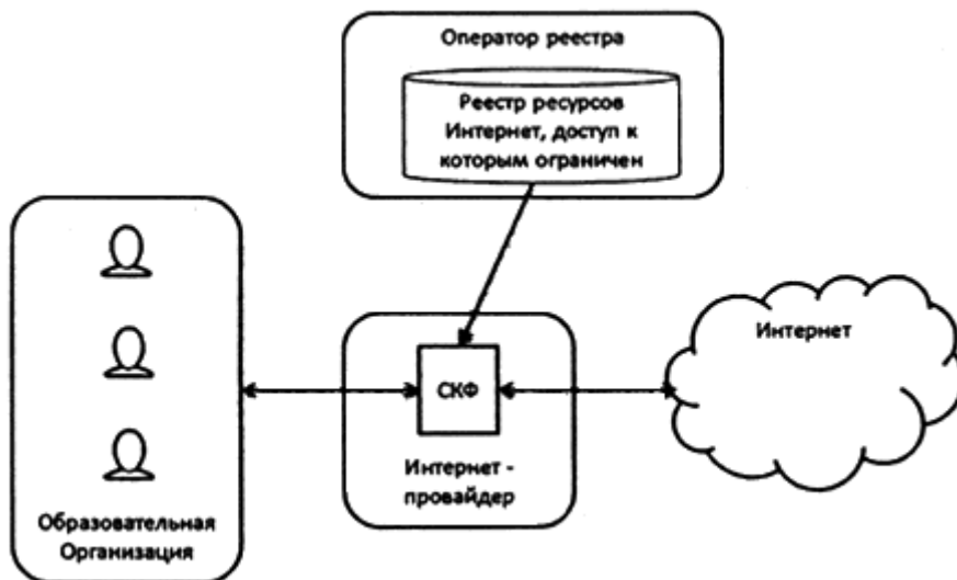
Рис.4. Схема работы контент-фильтрации при размещении у интернет-провайдера
